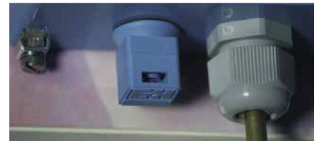
La membrana de Gore-Tex® del cabezal de campo en detalle
